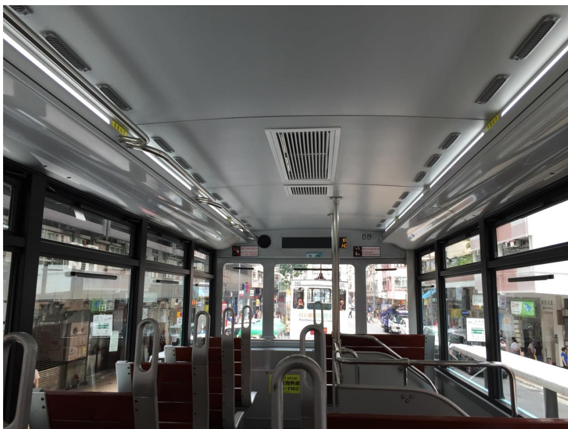
圖片 2：於屈地街電車廠內製造的 88 號電車，配備空調系統，此系統亦能轉換成普通
